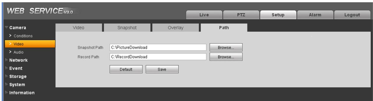
Figure 4-5. Настройка пути сохранения моментальных снимков и видео.
