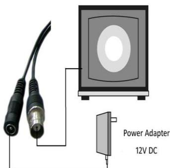
Рис.2.5. Коммутация разъемов видеокамеры
