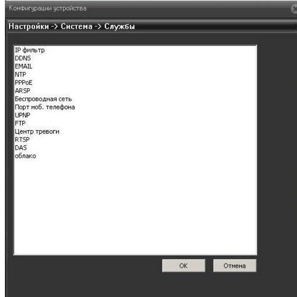
Раздел позволяет настроить различные сетевые функции камеры.
