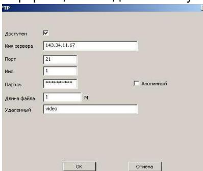
**6.3.4.5** Раздел «FTP» позволяет настроить запись файлов на виртуальное хранилище (FTP – сервер). FTP-сервером может быть как жесткий диск, подключенный к роутеру, так и открытый (закрытый) сервер – хранилище файлов.
