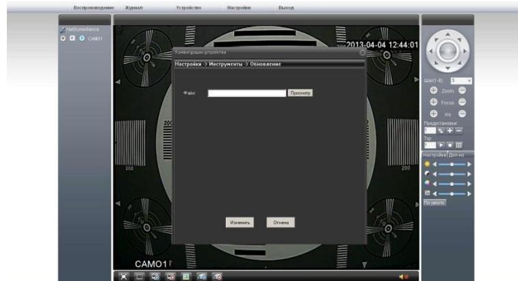
Раздел позволяет осуществить обновление прошивки камеры.
