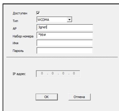
Нажимаем ОК в 2-х окнах, появится подсказка «Настройки сохранены, необходимо выполнить перезагрузку». Нажимаем ОК. После перезагрузки, в строке IP адрес должен появиться полученный IP адрес.
