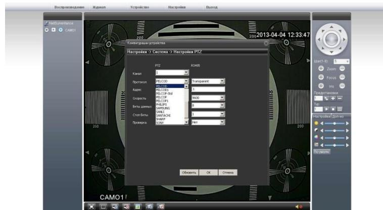
Раздел позволяет настроить элементы дистанционного управления поворотным устройством IP-камеры. Управление камерой поворотным устройством осуществляется по протоколу RS485.
