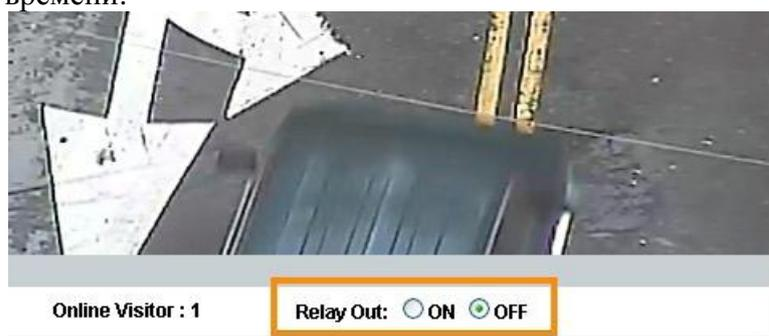
Time Switch: Реле времени: Камера вызывает внешнее устройство и сигнал длится в течении некоторого времени, в соответствии с условиями интервала и вручную остановить сигнал не разрешено пользователю.
