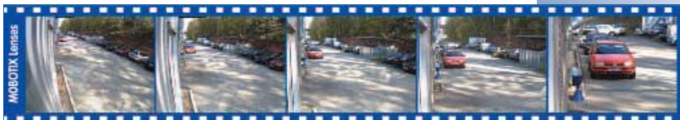
Суперширокоугольный объектив L22 Около 90°(гориз.) x 67°(вертик.) На расст.10 м, зона пригл. 20,0 x 13,3 м
